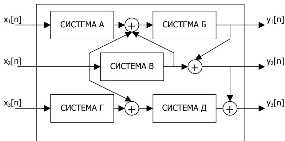
**Рис.5-8. Свойство линейности для систем с кратными входами и выходами.**
