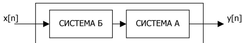
**Рис.5-7. Свойство коммутативности для линейных систем.**
