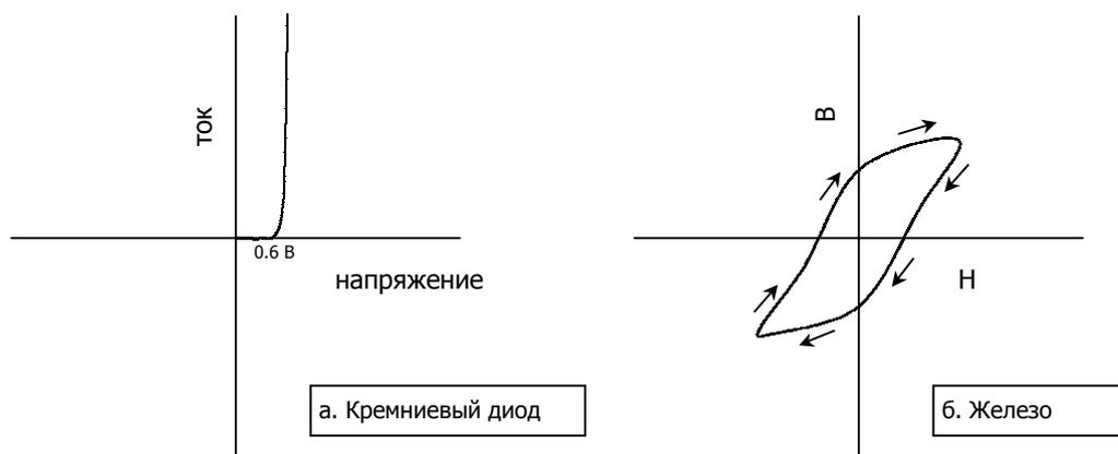
Рис.5-6. Два примера нелинейных систем.
