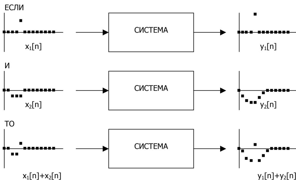
**Рис.5-3. Определение аддитивности.**
