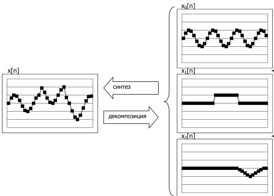
**Рис.5-10. Иллюстрация синтеза и декомпозиции сигнала.**
