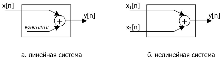
**Рис.5-9. Линейность при умножении.**
