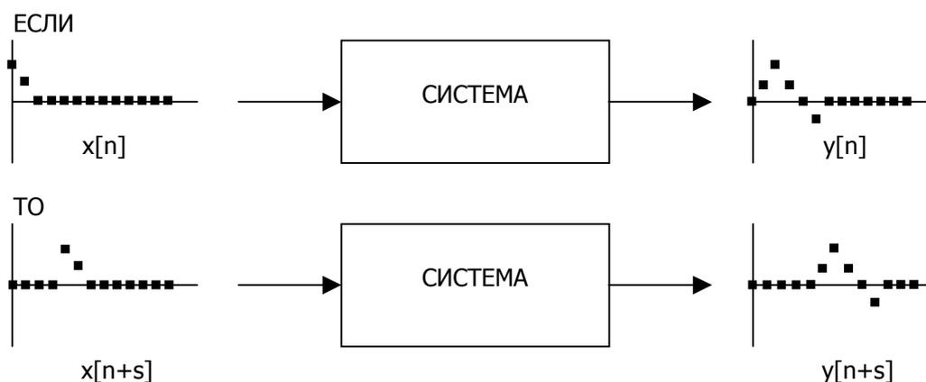
**Рис.5-4. Определение инвариантности относительно смещения.**
