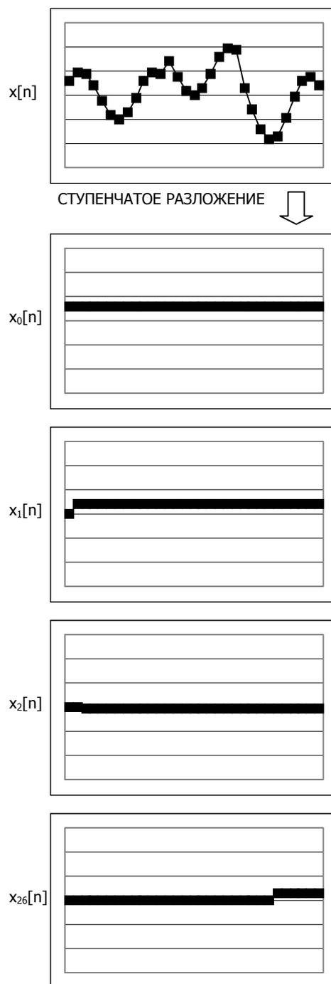
Рис.5-12. Импульсное разложение.
