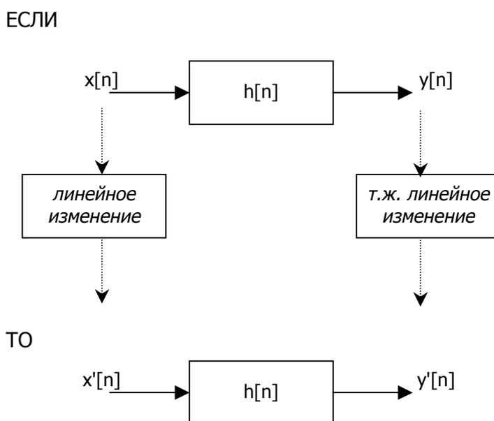
**Рис.7-11. Свойство переноса между входом и выходом.**
