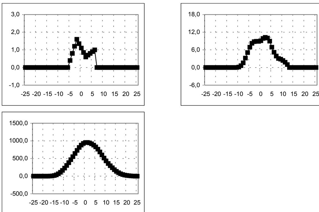
Рис.7-12. Пример свертки импульсовидного сигнала с самим собой.
