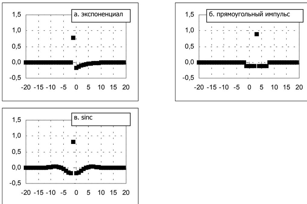
**Рис.7-5. Примеры импульсных характеристик ВЧ фильтров.**
