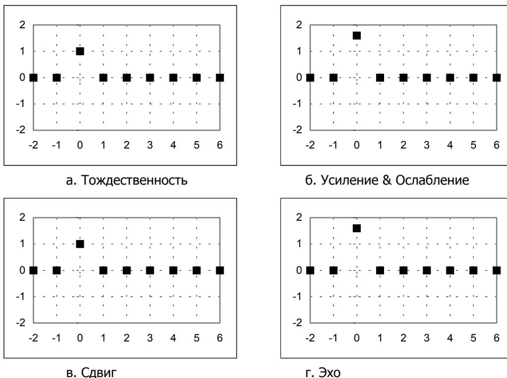
**Рис.7-1. Простые импульсные характеристики с использованием смещенных и масштабированных дельта-функций.**
