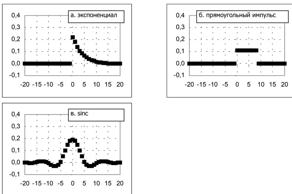
**Рис.7-4. Примеры импульсных характеристик НЧ фильтров.**
