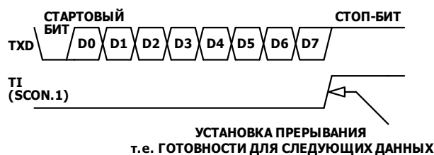
Рис.40. Передача по Последовательному Порту UART, Режим 1.
